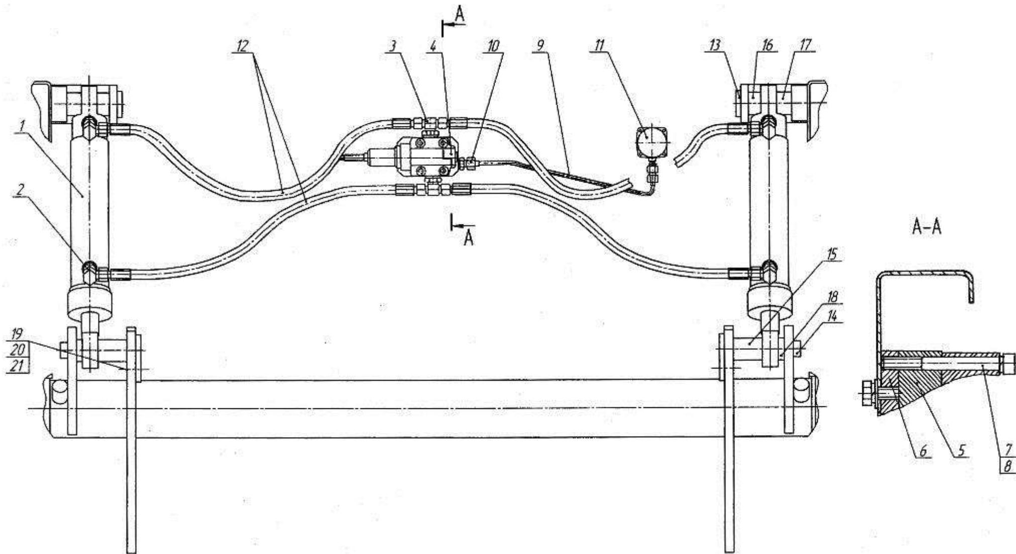
Рисунок 20 – Гидравлическая система балансира натяжения прессующих лент
