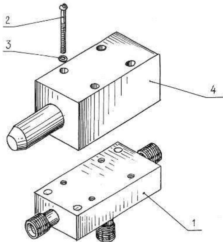
Рисунок 21А – Гидрораспределитель ПС-30.07.15.000
