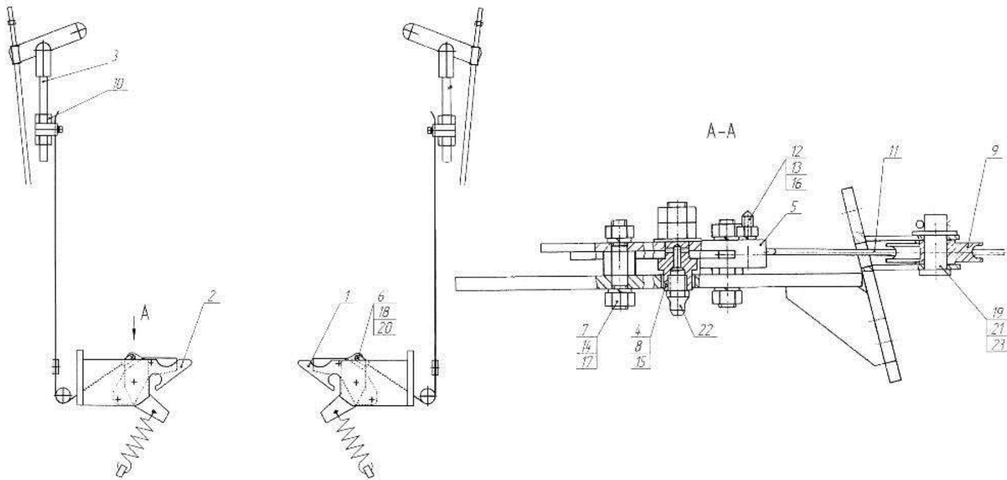
Рисунок 22 – Механизм обрезаки шпагата
