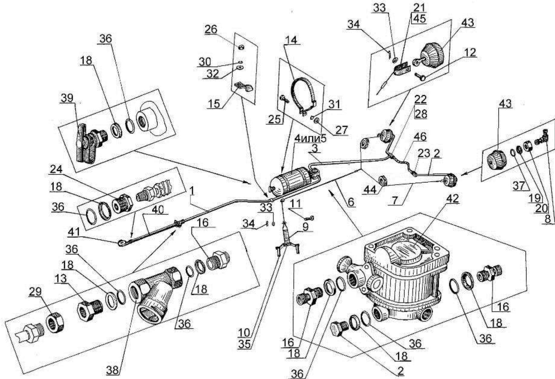
Рисунок 4 – Система тормозная /ПС-30.01.02.000/
