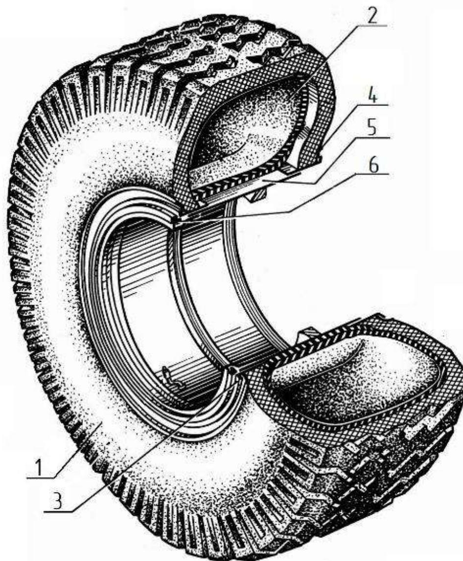
Рисунок 3.4 – Колесо с шиной /086СХ12,8-06.020/
